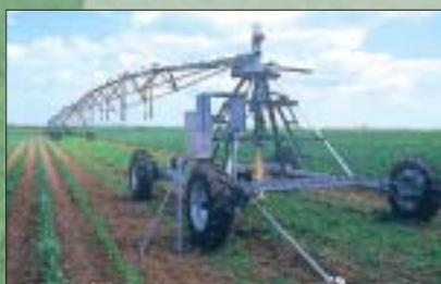
Conçue pour des parcelles même de formes irrégulières, la motrice Omega, 4 roues 14,9/13 x 24, 2 ou 4 moteurs, à guidage de surface par sillon ou par câble aérien, permet d'irriguer automatiquement en mode frontal et en mode pivot.
